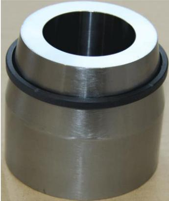
Verwenden Sie zur Montage der PTFE-Dichtung eine Montagebüchse und eine Montagehülse. Legen Sie die PTFE-Dichtung über die Montagebüchse.
