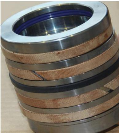
Setzen Sie nun die restlichen Führungsbänder wie bereits in Abb. 4 und 5 beschrieben ein und wiederholen Sie die Kalibrierung aus Abb. 20. Achten Sie jedoch darauf, dass die Kalibrierhülse alle Dichtungen umschließt.
