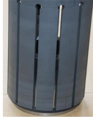
Wenn Sie die PTFE-Dichtung an das Ende der Montagebüchse gedrückt haben, können Sie wahlweise die Montagehülse entfernen oder nicht. Wir empfehlen Sie nicht zu entfernen, da Sie später wieder benötigt wird.
