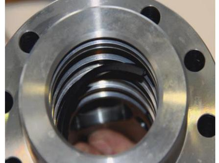
Formen Sie das Führungsband auf den entsprechenden Durchmesser der Führung vor und setzen Sie es in den richtigen Einsteich ein.
