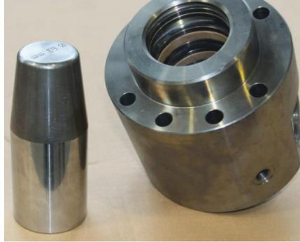
Nehmen Sie einen Montagedorn, dessen Durchmesser dem Innendurchmesser der Führung entspricht.
