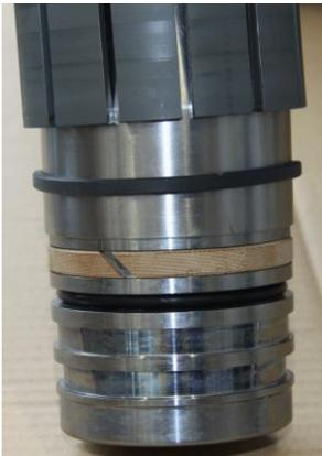
Setzen Sie die Montagebüchse auf den Kolben. Die Montagebüchse sollte dabei mit dem oberen Rand des montierten Führungsbandes bündig sein.
