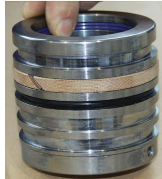
Setzen Sie das Führungsband in die dafür vorgesehene Nut ein. Mit diesem Zwischenschritt wird verhindert, dass die PTFE-Dichtung beim Montieren in den Einstich für das Führungsband rutscht.
