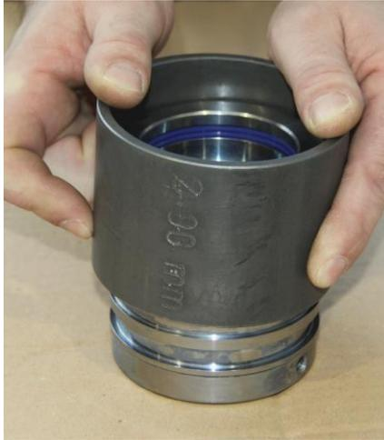
Durch das Montieren der Montagebüchse ist die Kolbendichtung leicht verformt worden.
