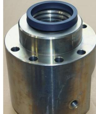
Fahren Sie mit einem gebogenen Ausstechwerkzeug (Abb.2) hinter die Stangendichtung.
