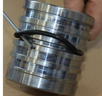
Nehmen Sie einen flachen, abgerundeten Schraubenzieher und montieren Sie den O-Ring in die Nut der Kolbendichtung.
