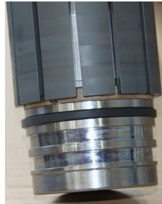
Entfernen Sie die Montagebüchse, wenn die PTFE-Dichtung vollständig in der Nut ist
