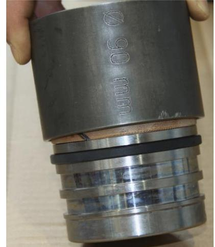
Um ein optimales Ergebnis zu erhalten, bleibt die Kalibrierhülse ca. 10 Sekunden auf dem Kolben bleiben.
