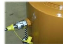
3. Nach einiger Zeit tritt anstelle der Luft schäumendes Öl aus. Somit ist der Hydraulikzylinder ordnungsgemäß entlüftet.
