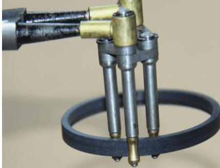
Die PTFE-Dichtung kann mittels einer Spezialzange oder alternativ zwischen zwei Fingern montiert werden.
