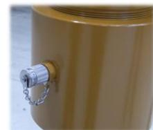
Dieser Vorgang muss bei beiden Entlüftungsmethoden mehrmals wiederholt werden, bis sich keine Luft mehr im AROS-Zylinder befindet. Erst dann ist die Entlüftung einwandfrei durchgeführt.
