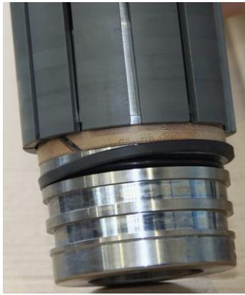
Drücken Sie nun die PTFE-Dichtung mit Hilfe der Montagehülse auf den O-Ring in die Nut.
