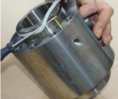
Nehmen Sie einen flachen, abgerundeten Schraubenzieher und setzen Sie das Dichtelement in die dafür vorgesehene Nut ein.
