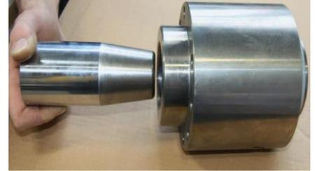
Führen Sie diesen in die Führung ein, um die ursprüngliche Form der PTFE-Dichtung wieder herzustellen.
