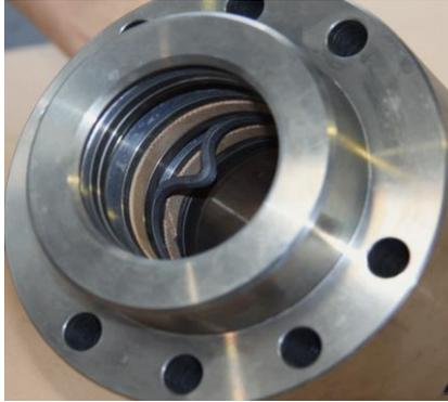
Drücken Sie anschließend die gesamte Dichtung in die Nut.
