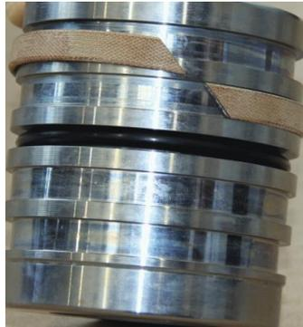
Klappen Sie das vorgeformte Führungsband leicht auf und streifen Sie es über den Kolben.
