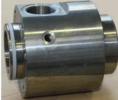
Überprüfen Sie, ob das Dichtelement einwandfrei montiert ist.
