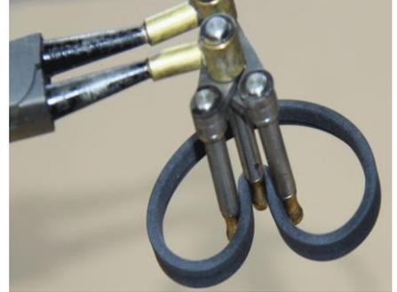
Formen Sie die PTFE-Dichtung nierenförmig um das Einsätzen in die Nut zu erleichtern.
