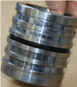
Den Schraubenzieher können Sie nun entfernen. Überprüfen Sie bitte, ob der O-Ring einwandfrei in der Nut eingesetzt ist.
