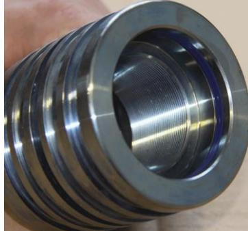
Drücken Sie anschließend das gesamte Dichtelement in die Nut und prüfen Sie danach die einwandfreie Montage des Dichtelements.
