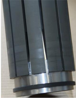
Drücken Sie anschließend mit der Montagehülse die PTFE-Dichtung an das Ende der Montagebüchse.
